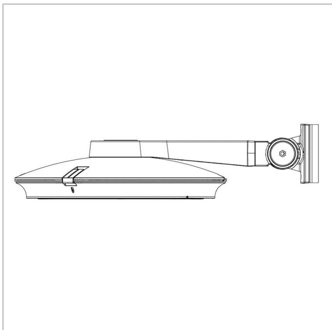
FLEXIA FG | Fixation avec console arrière sur rotule (WM)
