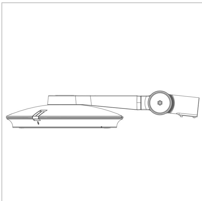
FLEXIA FG | Fixation latérale pénétrante Ø48 mm sur rotule (A5)
