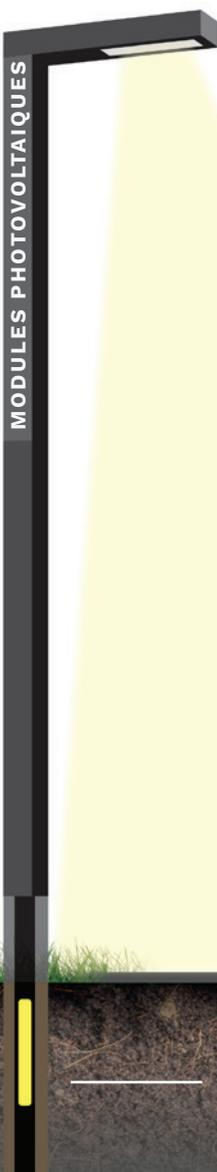
Batterie encastrée dans le sol pour une durée de vie plus longue (gestion thermique) et une protection contre le vol
