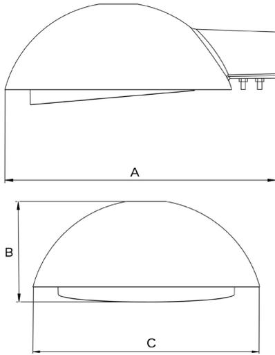
VALSSI | Mastansatzmontage für einen Mastzopf mit  $\varnothing 60$  mm
