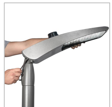
L'angolo di inclinazione può essere regolato in loco per entrambe le configurazioni testa palo (da 0 a +15°) e montaggio laterale (da 0 a -15°).
