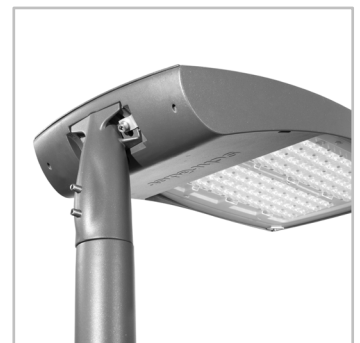
La gamma TECEO GEN2 offre fissaggi universali per attacchi da Ø32 a Ø76mm. E' anche disponibile un codolo penetrante Ø60mm.
