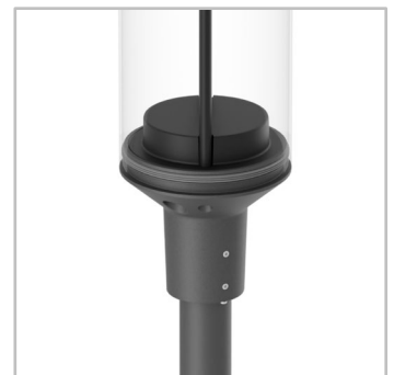
Les composants internes au protecteur du ZYLINDO GEN2 sont peints en noir afin de limiter le renvoi de lumière vers le ciel (ULR 0 %).
